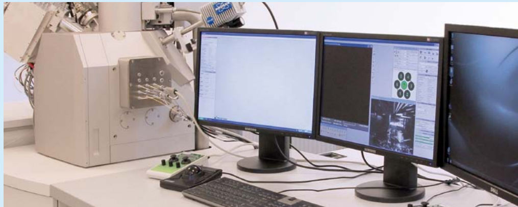
Das Fiblys-System, integriert in ein Rasterelektronenmikroskop
