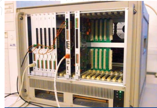
Hardware-in-the-Loop. Prototypenelektronik zur Abbildung der Assistenzfunktionen
