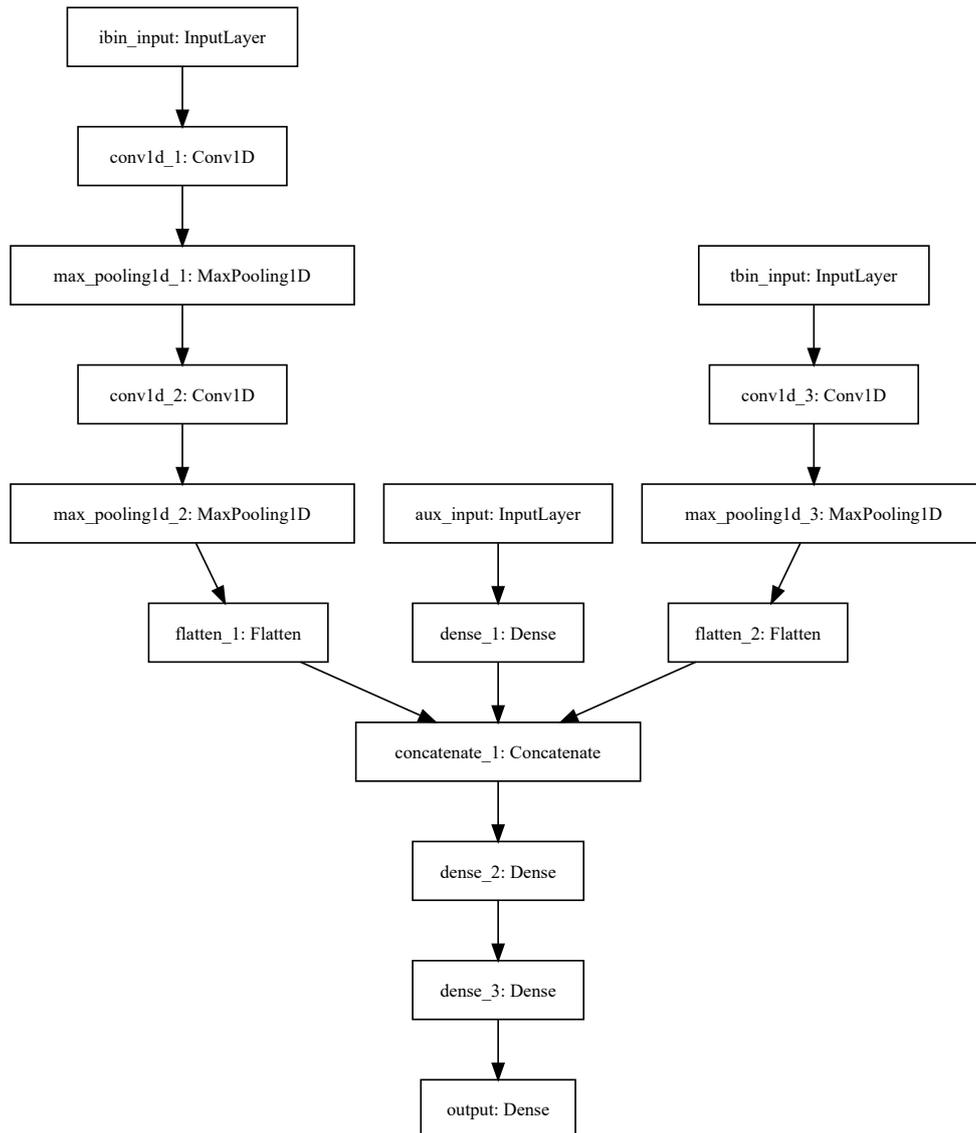
Abbildung A.15: CNN6: Convolutional Neural Network
