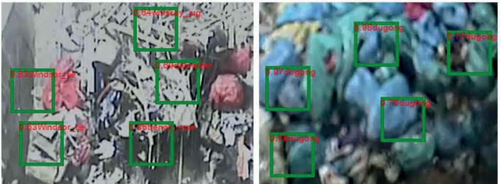
Abb. 3: Originaldarstellung und Erkennung von Abfall im Trichterbereich [EE21]
